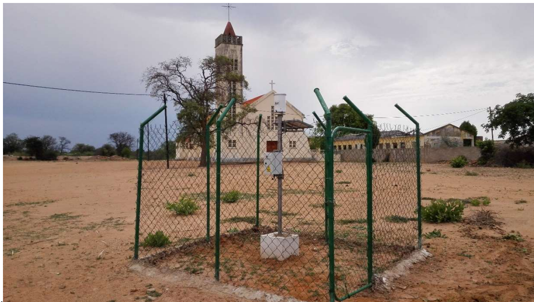
Instalação em campo estação udométrica
